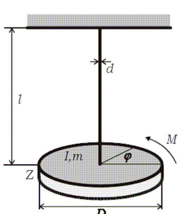
Ak teleso  $Z$ , zavesené na skrútenom drôte pootočíme a pustíme, torzné sily skrúteného drôtu ho budú vracať do rovnovážnej polohy a teleso sa rozkmitá rotačnými (torznými) kmitmi okolo osi symetrie idúcej osou periodicky skrúcaného drôtu.
